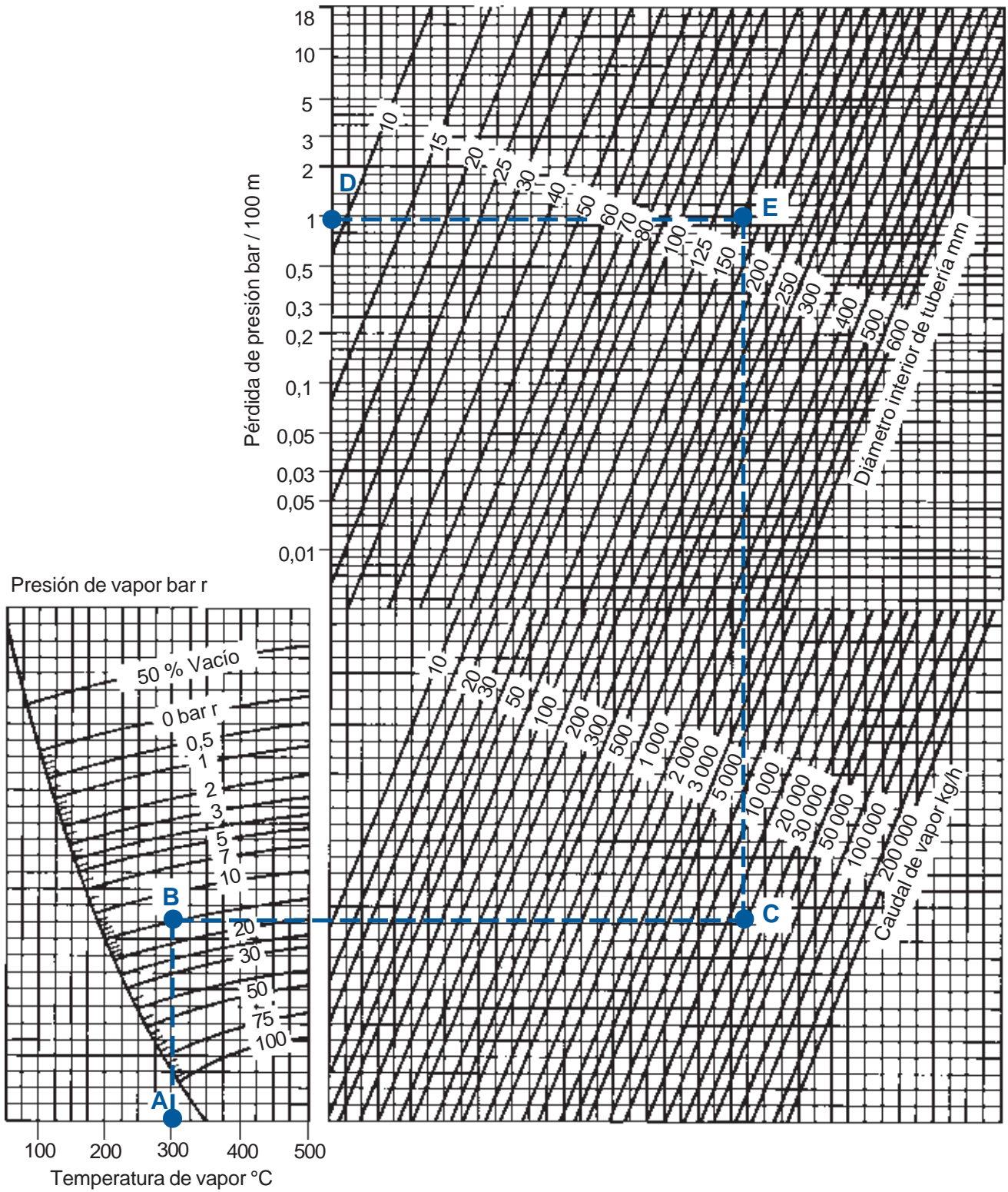
Fig. 7 Gráfico de dimensionado de tuberías de vapor (método de la caída de presión)
