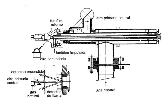
Quemador de combustión central. La caña de gas es concéntrica y exterior al atomizador de fuelóleo.
