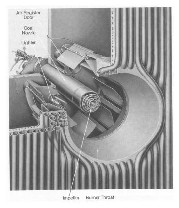
Disposición de un quemador circular de carbón pulverizado con registro de aire y garganta refrigerada por agua.
