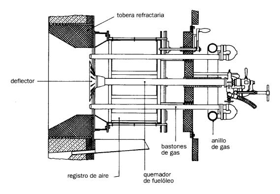
Quemador mixto de fuelóleo y gas con bastones (tipo "spud") y registro de aire. El suministro de gas se realiza a través de bastones dispuestos circularmente alrededor del atomizador de fuelóleo.
