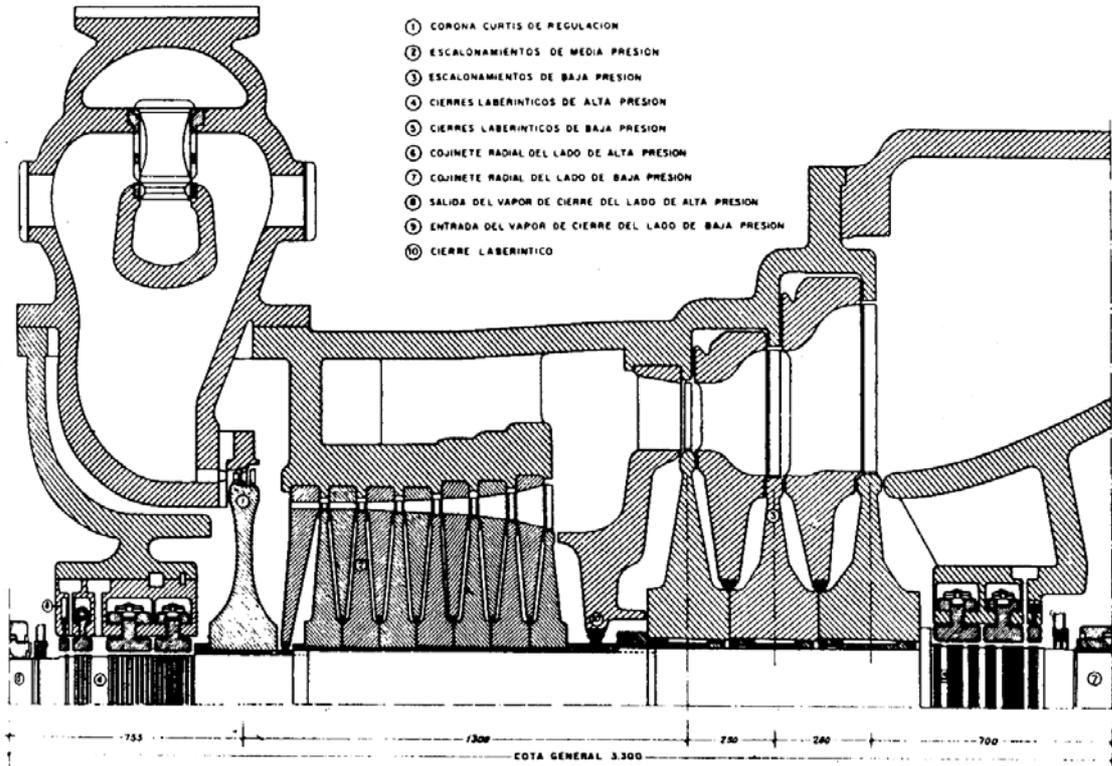
**Turbina de acción.** Presenta una primera rueda Curtis de doble escalonamiento de velocidad, seguida de un grupo de 7 escalonamientos de presión, con álabes montados en discos, en los que va aumentando la longitud del álabes aunque manteniendo el mismo diámetro en los tres primeros; le siguen 3 escalonamientos de baja presión, de longitud de álabes y diámetro crecientes
